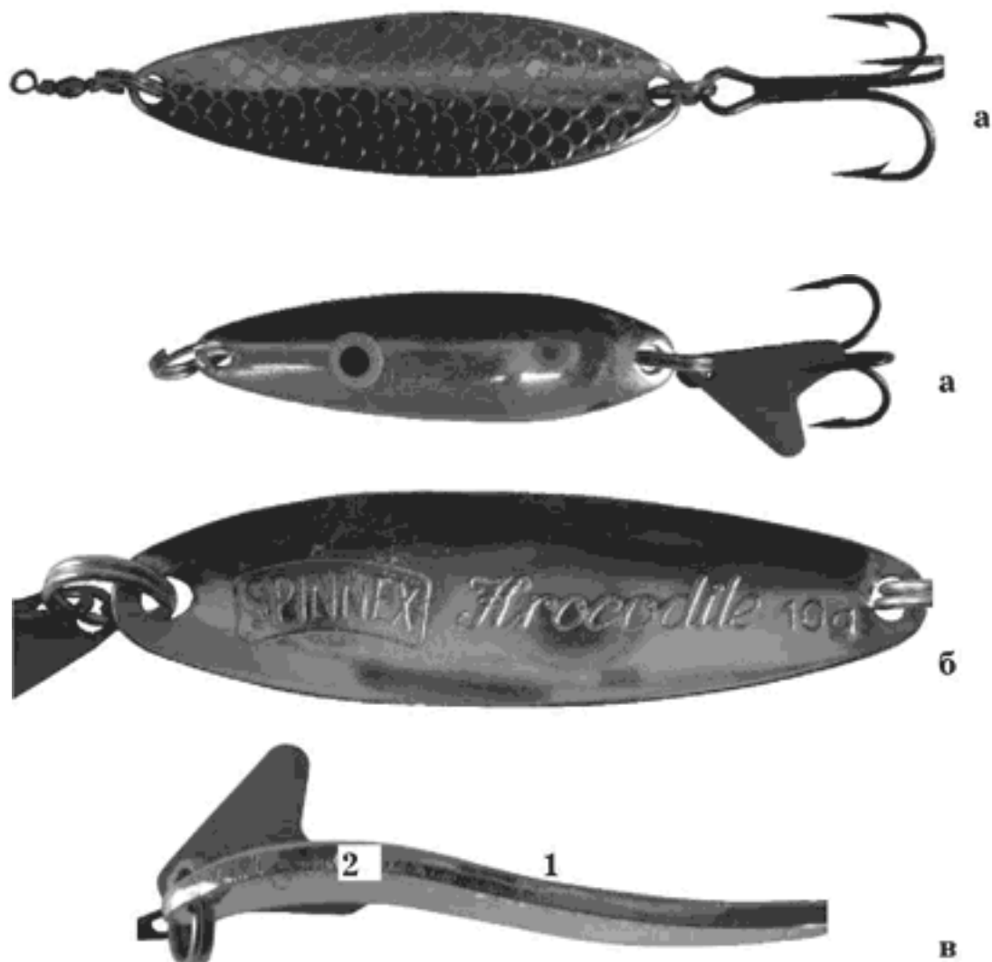
Фото 11. Китайская версия блесны Krocodile (вес 10 г): а – внешняя сторона; б – внутренняя сторона; в – дефекты:
