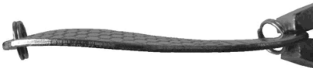
Фото 7. Профиль китайской версии блесны Шторлек с недогибом передней плоскости
