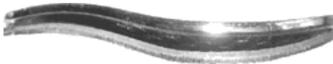
Фото 2. Несоответствие профилей изгибов блесен Атом-2, изготовленных на одном заводе, но в разное время
