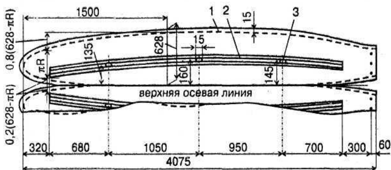
Рис. 68. Раскрой обтекателя поплавка: 1 — шов; 2 — карман стрингера; 3 — вырез под гак узла крепления
