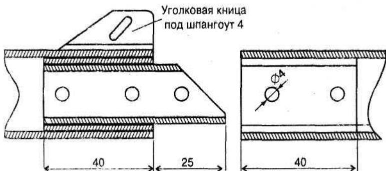
Рис. 45. Стыковка кильсона
